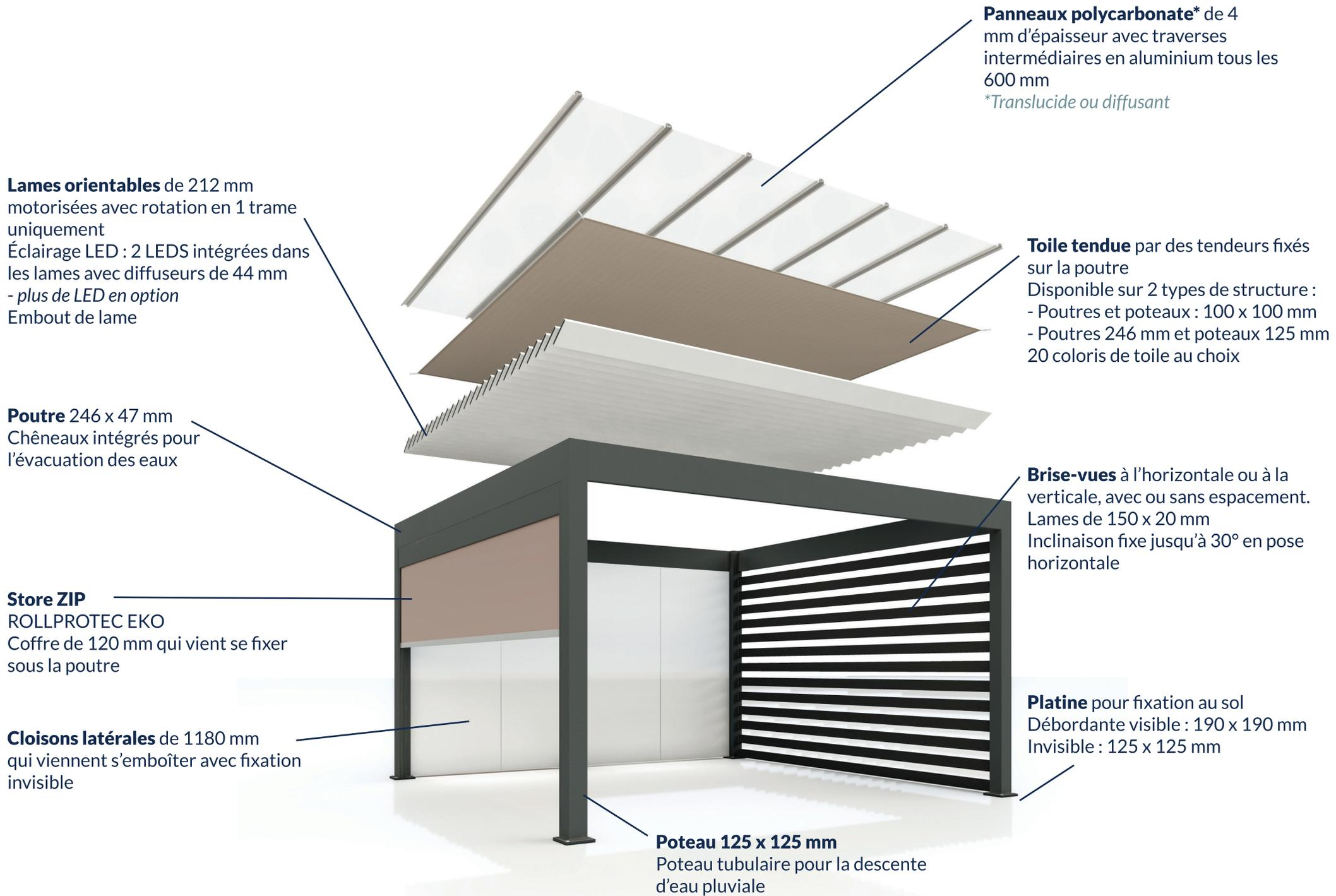
**Panneaux polycarbonate\*** de 4 mm d'épaisseur avec traverses intermédiaires en aluminium tous les 600 mm
